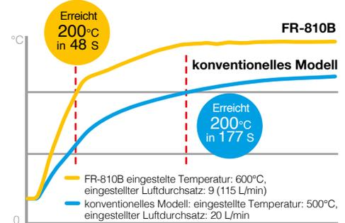
\* Untersuchung der Zeit, die benötigt wird, um Lotverbindungen auf einem Keramikboard auf 200°C zu erwärmen, bei eingestellter Maximaltemperatur und maximalem Luftdurchfluss. Es wurden Düsen mit einem Durchmesser von ca. 4 mm verwendet.
