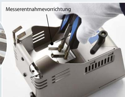
Schieben Sie die Klingen in die Messerentnahmevorrichtung.
