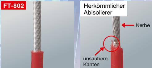
FT-802 kann AWG 38 bearbeiten ohne Kerben zu hinterlassen.
