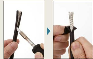
Der Messereinsatz für FT-8003 ist für das Abisolieren von starken Kabelsträngen geeignet.
