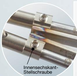
Lösen Sie die Schrauben an den Klingen.
