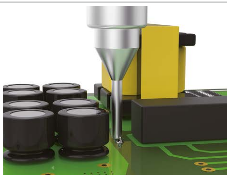
lange Düsenformate für enge Bestückung Schlanke und lange Düsen für schwer zu erreichende Orte.
