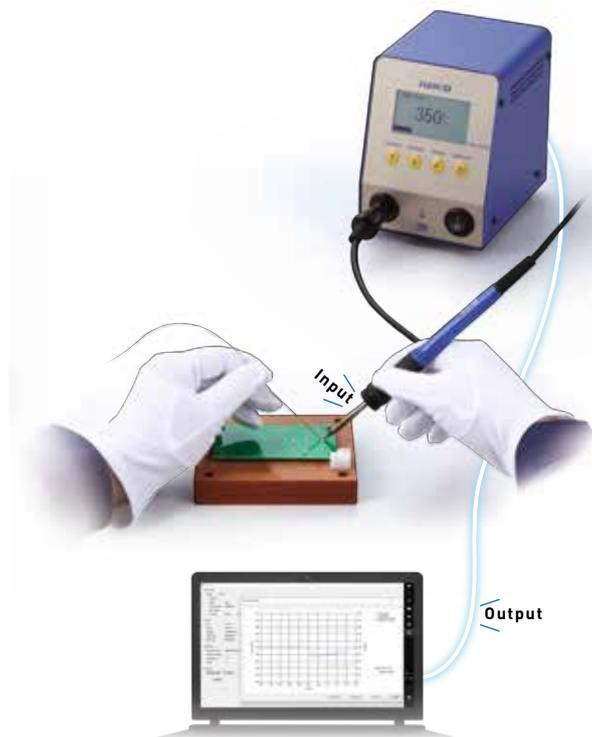
Die „unsichtbaren“ aber wichtigen Faktoren des Lötprozesses werden direkt sichtbar. Die gesammelten Daten können Aufschluss und Impulse für wichtige Optimierungsschritte geben.
