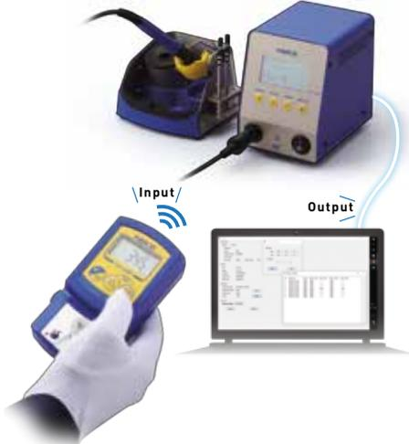
Es wird automatisch ermittelt, ob die Messergebnisse innerhalb der vorab eingestellten Toleranzgrenzen liegen. Liegt der gemessene Wert innerhalb der vorgegebenen Grenzen geht die Station in den Arbeitsmodus, liegt der Wert nicht innerhalb der Grenzen, wird automatisch der Off-Set Wert ermittelt und entsprechend eingestellt.
